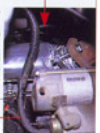
そして取り付け。マニフォールド側のボルトは締め付けにくく、均等に締めていくのは至難の業。全部が全部ではないのだが、何本かのボルトはかなり手の届きにくいところにある。OEMのエキゾーストマニフォールドのボルトの方が断然締めやすい。
