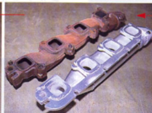
OEMマニフォールドとログヘダースとの比較。確かにこの形状だったら、ノールームのHEMIラムでもどこにも干渉することはない。
