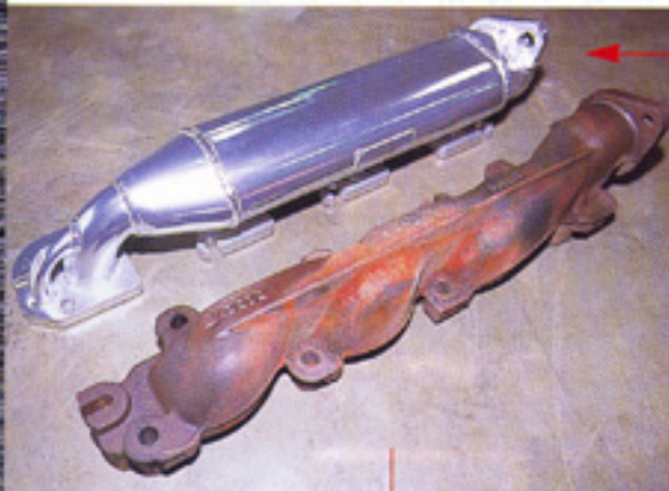
OEMマニフォールドとログヘダースとの比較。確かにこの形状だったら、ノールームのHEMIラムでもどこにも干渉することはない。
