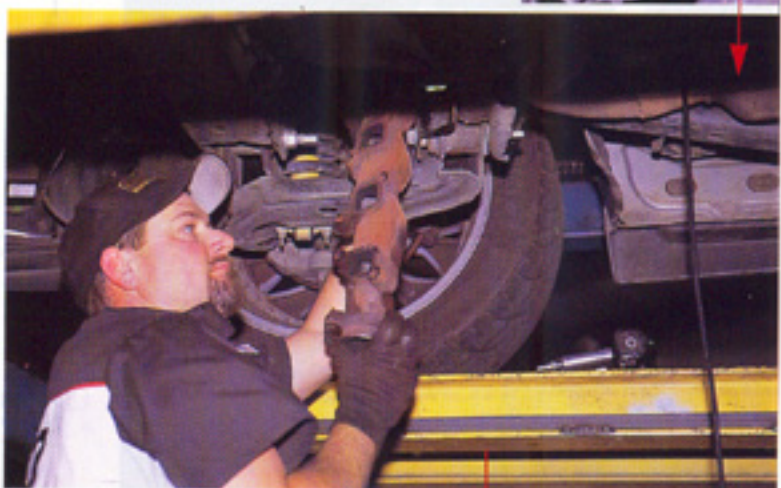
まずエキゾーストマニフォールドのボルト側に2列あるボルトを外す。そして、すべてのボルトを外してエキマニを外す。
