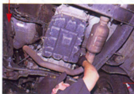
ストックのエキゾーストマニフォールドを外す。リアに繋がる2in1パイプ(ヘッドパイプ)をまず左右2本ずつのボルトで外し、ヒートシールドを取り除く。
